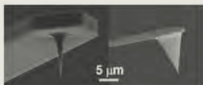
Fig. 17 Foto ottenute con microscopio elettronico (SEM) di due cantilever con punte di dimensioni differenti; destra: schema di funzionamento dell'apparato AFM
